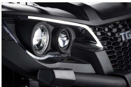
Polyellipsoid- und Halogenscheinwerfer mit LED-Multifunktionslicht
