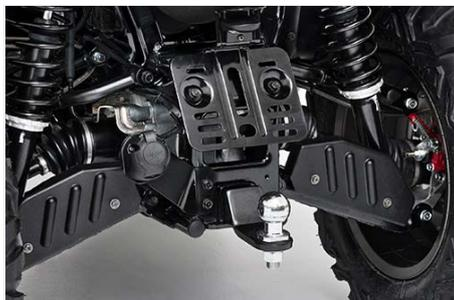
abnehmbare Anhängerkupplung und Steckdose, Einzerradaufhängung vorne und hinten
