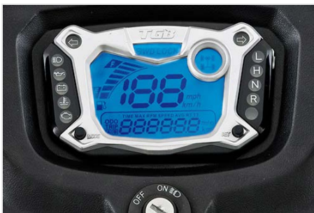
Blue-Backlight multifunktionale Digitalarmatur mit Drehzahlmesser und Tankanzeige
