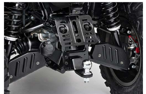
abnehmbare Anhängerkupplung und Steckdose, Einzelradaufhängung vorne und hinten
