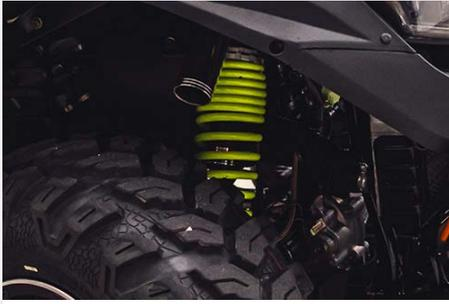
Verstellbare Gasdruckfederbeine und Einzelradaufhängung
